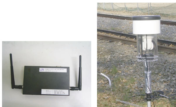
(a)メッシュルータ (b)フィールドサーバー 図1 市販機器の例
