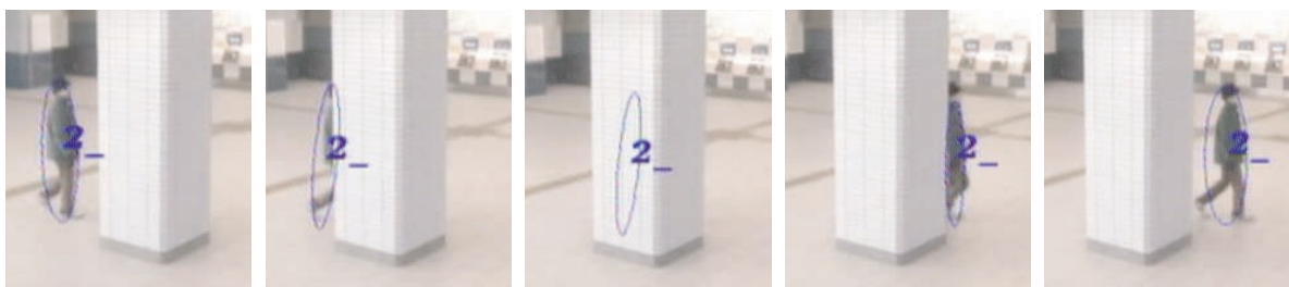
図7 カルマンフィルタによる隠れに頑強な追跡アルゴリズム
