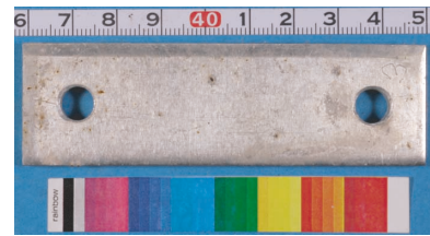
図7 6ヶ月間暴露したアルミニウム合金（単体試験片）の外観
