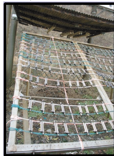
図4 勝木塩害試験場における試験片の暴露状況
