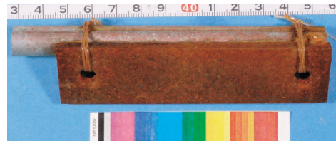
図6 6ヶ月間暴露した鉄と硬銅トリ線線の異種金属接触腐食試験片の外観
