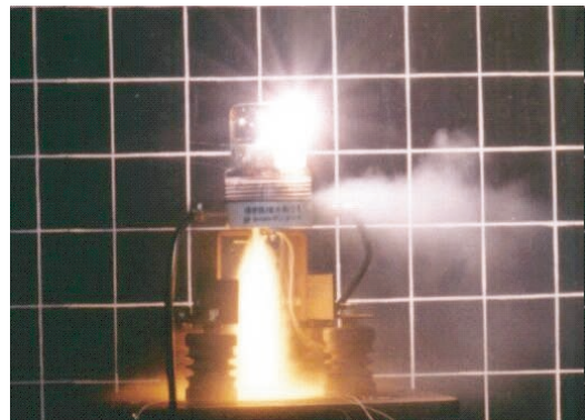
図16 地絡模擬放電電流試験の様子
