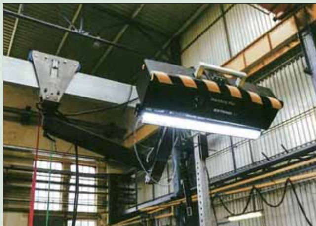
Werklicht Pro は構造部品に CAD 情報を直接投影する
