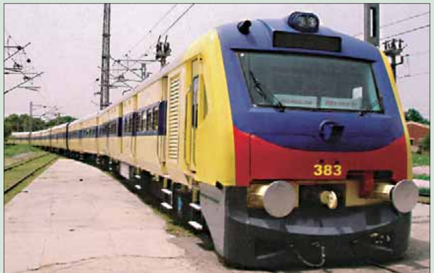
車体幅を狭くした普通列車や近郊列車用MEMUは主要な25kv電化路線でも運用されている
