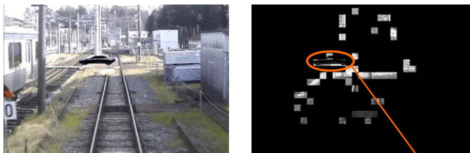
図7 エッジ&テクスチャ解析モジュールによる画像認識結果 障害物の検出
