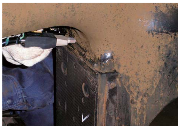
図7 ACFM プローブによる台車枠の探傷
