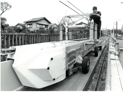
④集電試験装置：国立研究所内に設置されたリニアモーターを利用した集電試験装置
