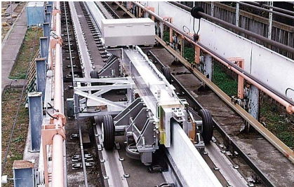
⑥永久磁石界磁の走行台車：希土類磁石で電磁石を置き換えた集電試験装置用の台車
