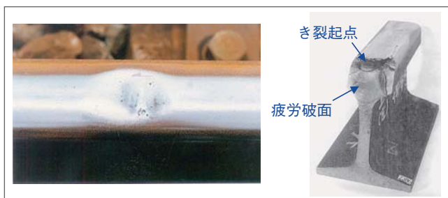
図1 シェリングの外観と破断面の例
