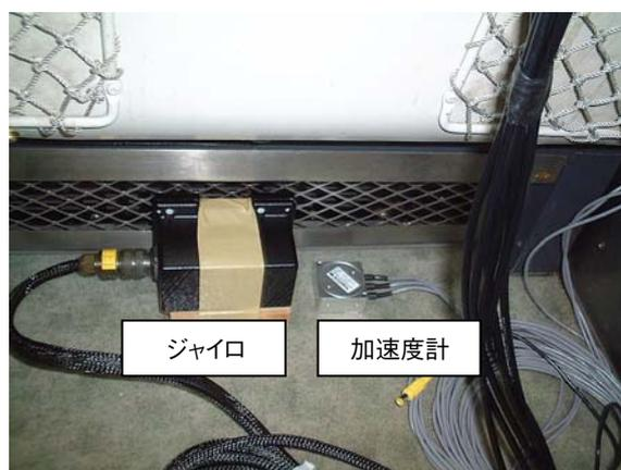
床面上に設置した加速度計と光ファイバジャイロ
