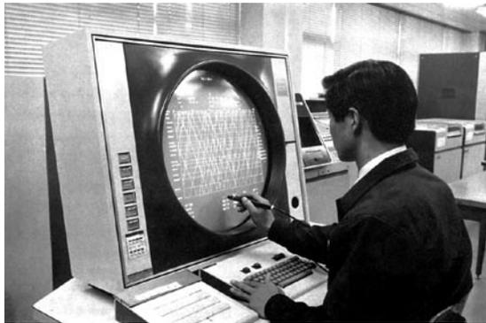
図2 マンマシンによる列車ダイヤ作成
